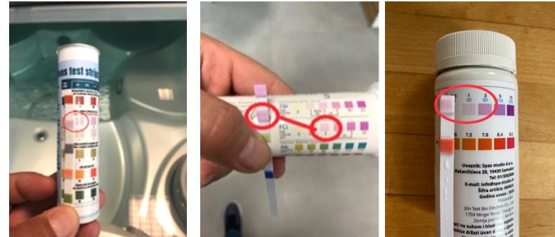
Slika 5. Očitanje koncentracije klora - ovisno o vrsti test trakica
