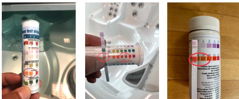
Slika 2. Očitanje pH vrijednosti – ovisno o vrsti test trakice
